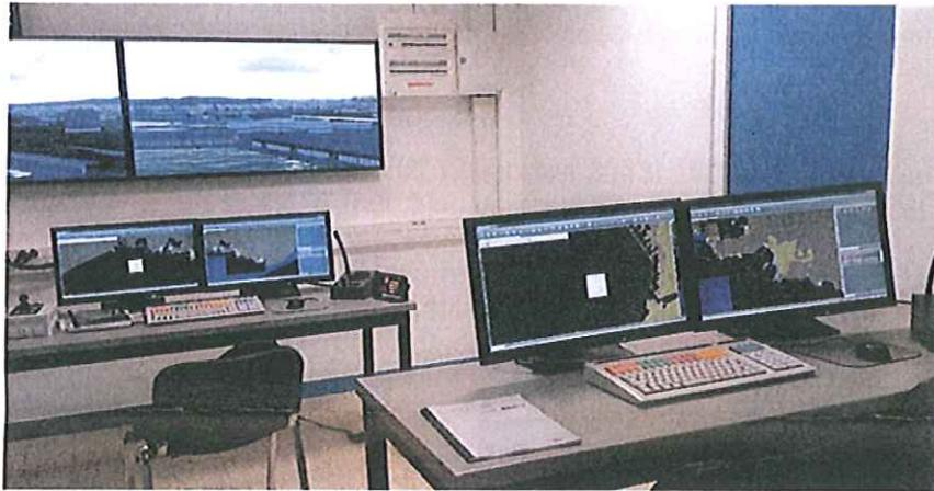
Un exercice a permis de constater le bon fonctionnement du simulateur. Des réglages de sonorité VHF restent à prévoir pour une meilleure compréhension des échanges entre les postes navires et les postes VTSO.
